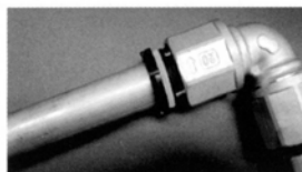
②標線が消えるまでパイプを挿入
