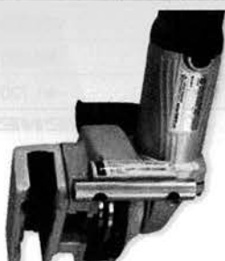
GX形P-Linkセット例 (GX形用面取りキットを 取り付けた状態)
