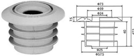
適用パイプ・接続管・口径・他 50φVP、VUジャバラホース32、38
