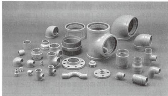
ライニング钢管用のねじ込み式管端防食管継手です。内面ライニング钢管用のRCF-K型（おもに屋内配管用）、異種管接続用のRCF-KZ型（異種金属接触防止型）、内面ライニング外面被覆钢管用のRCF-MK型（おもに埋設配管用）の3種類があります。
