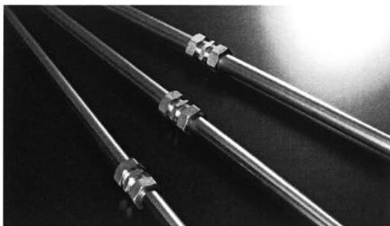
ステンレス鋼銅管・銅管兼用型の継手です。袋ナットの締付けによりスリーブが管に圧着し、流体のシールおよび管の抜け出しを阻止する圧縮式の管継手です。
