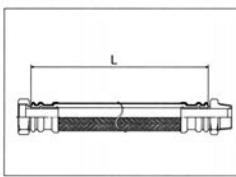
※継手本体の標準接続は一端が袋ナット（平行ねじ）でパッキン付、他端は外ねじ（テーパーねじ）です。
