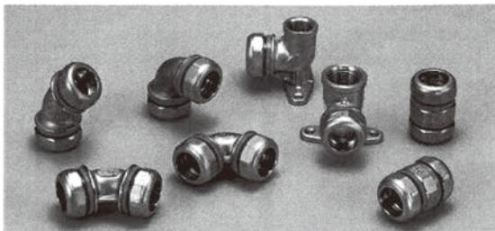
専用工具を使用して管を拡管することにより、強い引き抜き阻止力を発揮するステンレス鋼管用のメカニカル接手です。施工性に優れ、作業も簡単に素早く行えます。また接手に装着されているFPカラーにより、締め忘れの確認も一目でできます。
