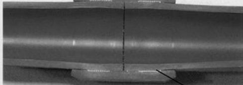
●EFソケットの構造 電熱線
