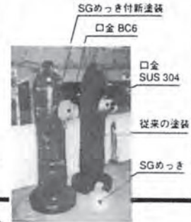
北海道登別温泉消防分署屋上にて SGめっき付新塗装耐久テスト中(平成7年3月より現在継続中)
